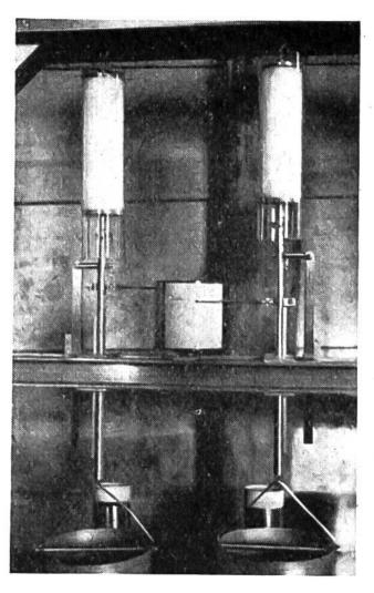
Zugapparat mit eingebauten Schneeproben.
