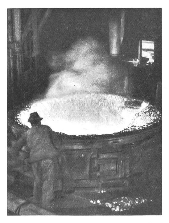
So sieht das Innere des Schmelzofens aus, wenn er entleert ist. Die Auskleidung aus feuerfesten Steinen ist weissglühend und strahlt eine ausserordentliche Hitze aus.
