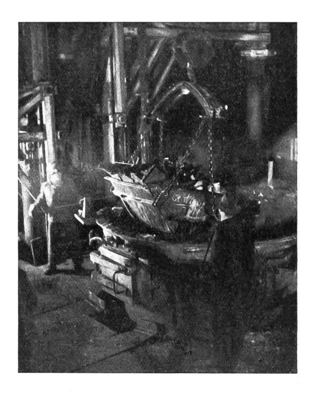
Das Altmaterial wandert in den Schmelzofen. Im Hintergrund rechts sind die grossen Elektroden sichtbar, die nachher in den Ofen eingetaucht werden. Zwischen ihnen und dem Schrott springen mächtige elektrische Funken, die das Alteisen zum Schmelzen bringen.
