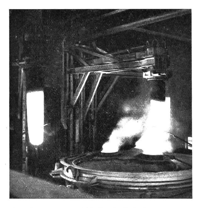
Der Schmelzprozess ist fertig; die Elektroden werden weissglühend aus dem gutverschlossenen Schmelzofen gehoben. Die Ofenwanne wird gekippt und das Eisen zu Blöcken gegossen.
