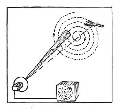
route dienen an Bord befindliche Mikrowellengeräte. Der scharf gebündelte Centimeterwellenstrahl des Senders wird durch Rotation Antennensystems des spiralförmig nach aussen geführt, wobei sich diese Bewegung in rascher Folge wiederholt. Der Strahl der zugeordneten Kathodenstrahl-
