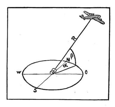
2. der Elevationswinkel (= Winkel  $\beta$  zwischen Richtstrahl und Grundfläche) und 3. der Azimut (= Winkel  $\alpha$  zwischen dem Nordstrahl und dem auf die Horizontebene projizierten Richtstrahl). 2 und 3 lassen sich ebenfalls durch die Richtstrahlen des Parabolspiegels bestimmen.
