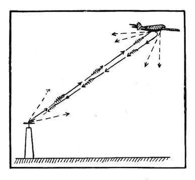
sich im Strahlungsbereich befindet, teilweise zurückgeworfen. Das "Echo" kommt zur Ursprungsquelle zurück und wird dort registriert. Im allgemeinen wird die Sendeantenne während der Impulslükken auch als Empfangsantenne für das "Echo" benützt.
