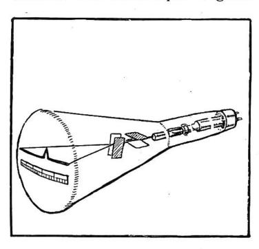
sendung eines Impulses und läuft, während der Impuls unterwegs ist, gleichmässig über die Röhre, einen horizontalen Strich beschrei-Der vom rückhend. kehrenden "Echo" ent-Spannungsstandene stoss erzeugt eine Zacke. An einem angebrachten Maßstab kann dann die Distanz direkt abgelesen werden.
