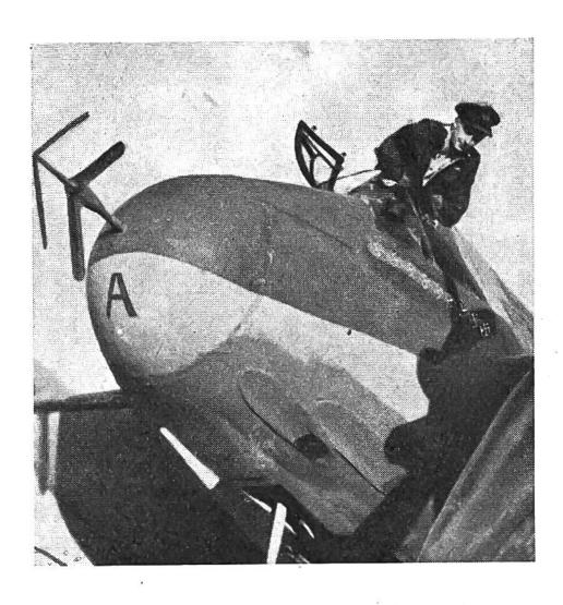
Flugzeug mit einer Radar-Antenne an der Spitze.
