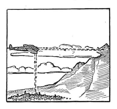
Panoramageräte ermöglichen auf ähnliche Weise, von einem Flugzeug aus das gerade überflogene Gelände mit einem feinen Wellenstrahl abzutasten. Die vom Boden reflektierten Echowellen verändern ihre Stärke je nach den getroffenen Gegenständen (Wasser reflektiert zum Beispiel nicht). Die Helligkeit des Strahls
