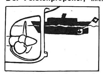
kommt immer mehr als moderner Schiffsantrieb zur Anwendung. Er wurde in seiner heutigen Bauart in der Schweiz entwickelt und zwar durch die bekannte Maschinenfabrik Escher Wyss, Zürich. Im Gegensatz zum festen Propeller besitzt er Flü-
