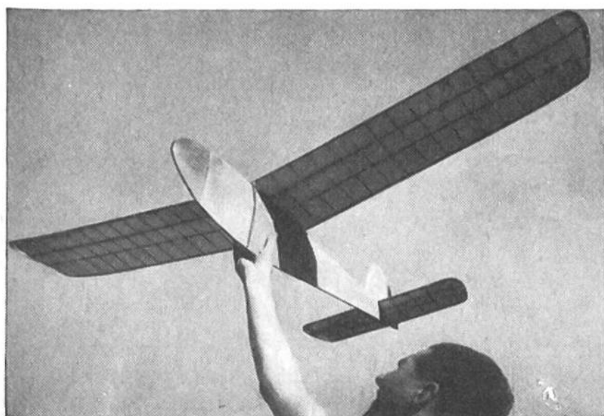
Leistungsmodell „Shell 3“ von 1,64 m Spannweite und 1,05 m Rumpflänge.
