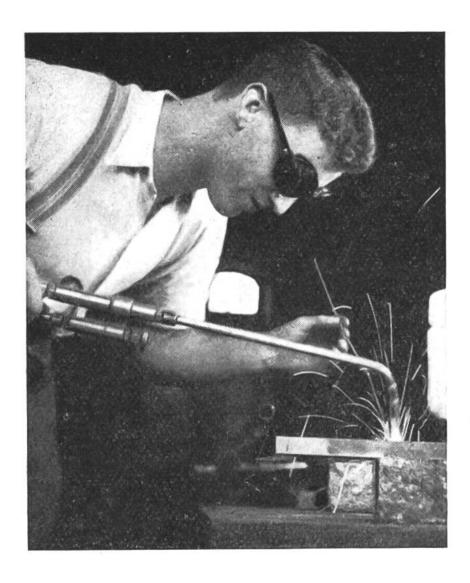
Auch das autogene Schweissen muss der Schlosser beherrschen. Dieses moderne Verfahren leistet bei der Eisenbearbeitung hervorragende Dienste. Die einfache Schutzbrille verhindert eine Verletzung der Augen durch die sprühenden Funken.
