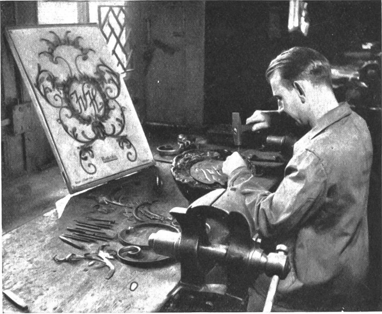
Ein Kursteilnehmer der Schlosserfachschule in Basel arbeitet nach einer Vorlage im Rokokostil. Tadelloses Aushauen, Rippen und Ziselieren kann nur mit Hingabe und Anstrengung erlernt werden.
