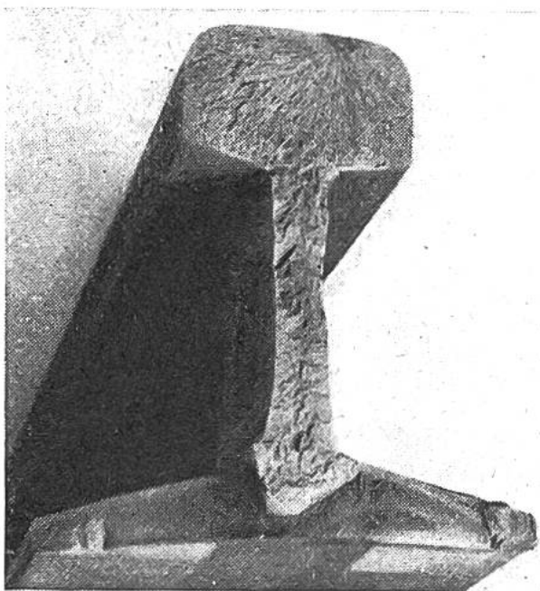
Abb. 8: Dauerbruch einer Schiene.
