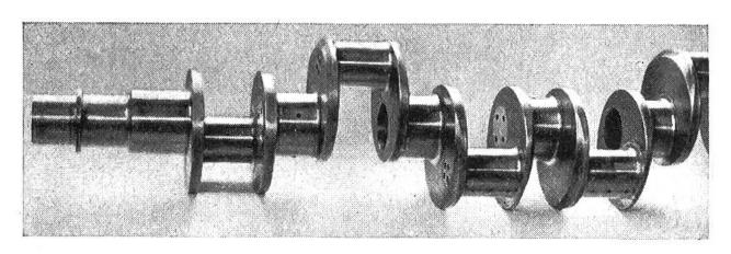
Abb. 3: Kurbelwelle eines Flugmotors.
