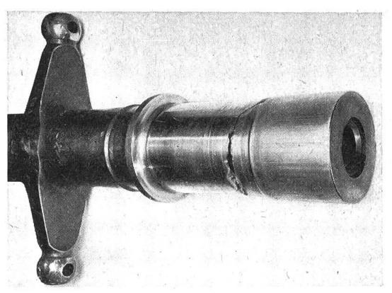
Abb. 5: Gebrochene Triebachse eines elektrischen Fahrzeugs.
