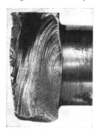
Abb. 4: Dauerbruch an der Kurbelwelle eines Lastwagens.
