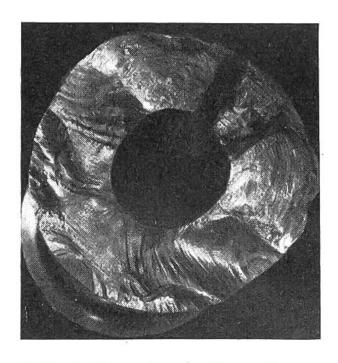
Abb. 6: Dauerbruch dieser Achse.
