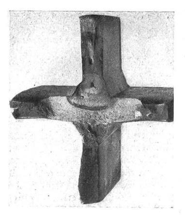
Abb. 2: Erm üdungsbruch am geschweissten Kreuzungspunkt einer Fachwerkstrebe.
