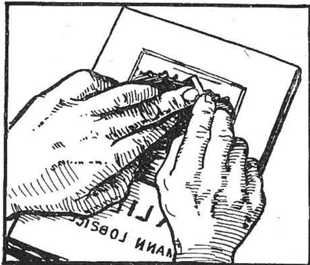
Stichels zu drücken. Ist der Stichel bis zum Umrißschnitt geführt, so springt das herauszuschneidende Holz durch leichtes Heben weg. Die Vertiefungen sollen überall etwa 2 mm betragen.
