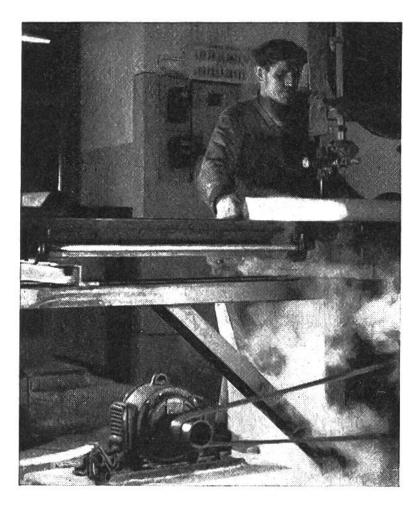
Die Trockeneis-Stangen werden für industrielle Zwecke in Stückevon 12 kg zersägt. Trockeneis ist ungefähr so hart wie Kreide. Es schmilzt nicht, sondern verdunstet; die dabei sich bildenden Dämpfe sinken zu Boden, weil sie schwerer sind als Luft.
