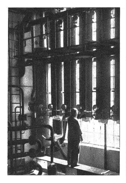
In diese zylinderförmigen Behälter, die Expansionsgefässe, wird flüssige Kohlensäure eingespritzt. Sie entspannt sich darin, u. durch die dabei entstehende grosse Abkühlung bildet sich ein feiner Kohlensäureschnee, der erstarrt, Trockeneis' ergibt.
