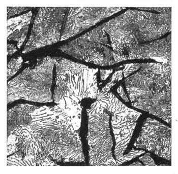
RostfreierStahl, der Chrom und Nickel enthält, besitzt wieder ein anderes Gefüge. Die Kristalle sind polyedrisch (vielflächig) und weisen öfters parallel verlaufende Striche, sog. Gleitlinien auf. Dieser, Austenit" ist unmagnetisch uzeichnet sich durch früh eintretendes Verschieben einzelner Kristallteile längs diesen Gleitlinien aus. (Ca. 100-fache Vergrösserung.)
