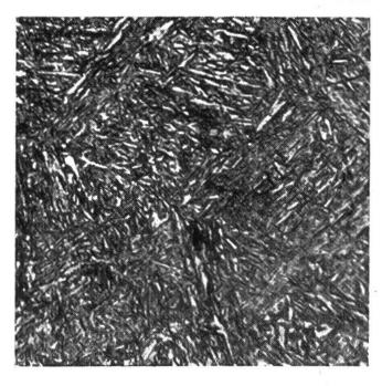
Kohlenstoffstahl. Das charakteristische Feingefüge (Mikrogefüge) eines geglühten Stahls lässt bei 200-facher Vergrösserung helle und dunkle Kristalle erkennen. Die hellen bestehen einheitlich aus Eisen und werden als Ferrit bezeichnet, die dunklen sind geschichtet u. heissen Perlit.
