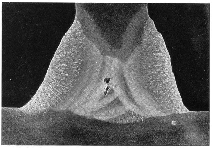
Elektrisch geschweisste Naht, die zwei Eisenbleche T-förmig verbindet. Man erkennt deutlich das Auftragen der Lagen beidseitig von innen nach aussen sowie die stenglige Ausbildung der Kristalle an den Rändern. Diese Erscheinung ist auf das Wachsen der Kristalle in bestimmter Richtung zurückzuführen. — Im Kern der Naht befindet sich ein Schweissfehler.
