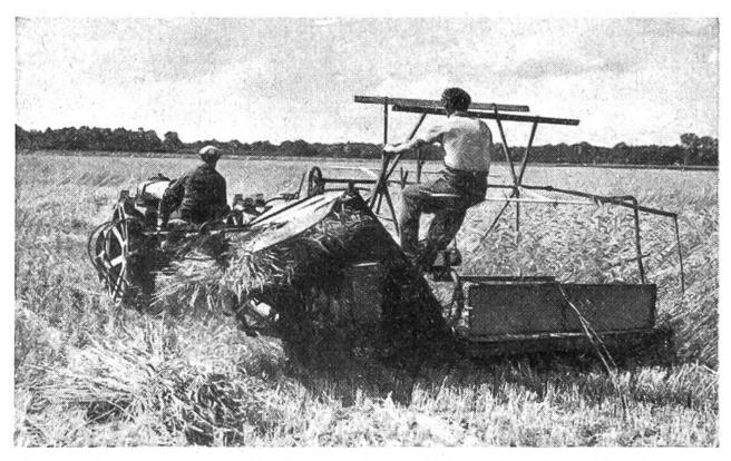
Der rotierende Haspel des Bindemähers drückt das Getreide so gegen das Maschinenmesser, dass die Halme mit den Ähren nach hinten auf das Transporttuch zu liegen kommen. Durch einen sinnreichen Mechanismus wird die köstliche Brotfrucht zu Gärbchen gebunden, welche die Maschine fortlaufend (links im Bilde) verlassen. Die kleinen Garben stellt man danach in sogenannten Puppen zum Trocknen auf.
