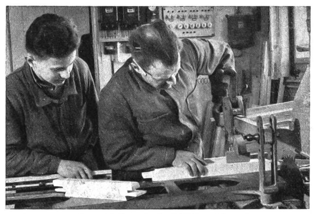
Glaserlehrling an der Kehlmaschine.
