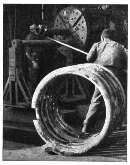
Rohrschlosserlehrling an der Biegemaschine.
