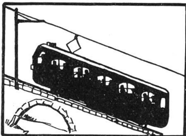
**Die steilste Zahnradbahn der Welt** ist immer noch die im Jahre 1889 eröffnete Pilatusbahn. Sie überwindet von Alpnach-Stad (441 m) bis zur Endstation Pilatus Kulm (2073 m) einen Höhenunterschied von 1632 m. Die Linie ist 4720 m lang und weist
