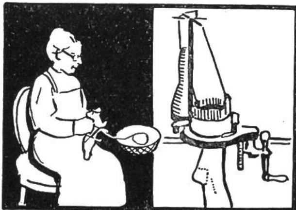
nötigt werden, verstrickt die Maschine 4800 m; dies natürlich, weil der Faden bedeutend feiner sein kann. Die Strumpfstrickmaschinen sind überhaupt wahre Meisterwerke der Technik. Sogar die Fersen- und Spitzenbildung wird vollständig automatisch ausgeführt. 600 Nadeln von je 0,15 mm Durchmesser sind ständig in Bewegung. Welch ein Unterschied zum Handstricken!
