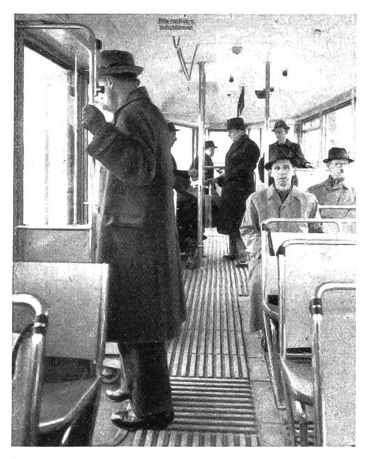
Innenansicht des modernen Strassenbahnwagens mit sogenanntem "Fahrgastfluss". Hinten links sitzt der Billeteur, an dem alle Fahrgäste vorbeigehen müssen.
