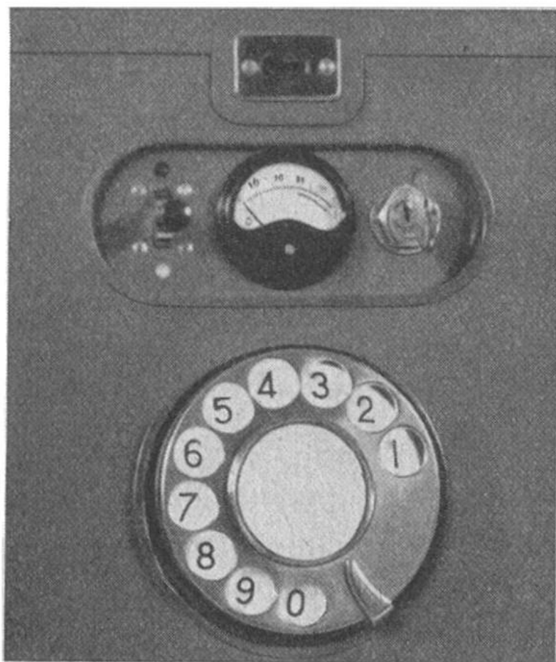
Teil eines Telephon-Apparates für drahtlose Telephonie. Oben: Schalter und Messinstrument zur Kontrolle der Batterien, Schloss zum Abschiessen gegen unbefugte Benützung des Apparates. Unten: Wählscheibe.
