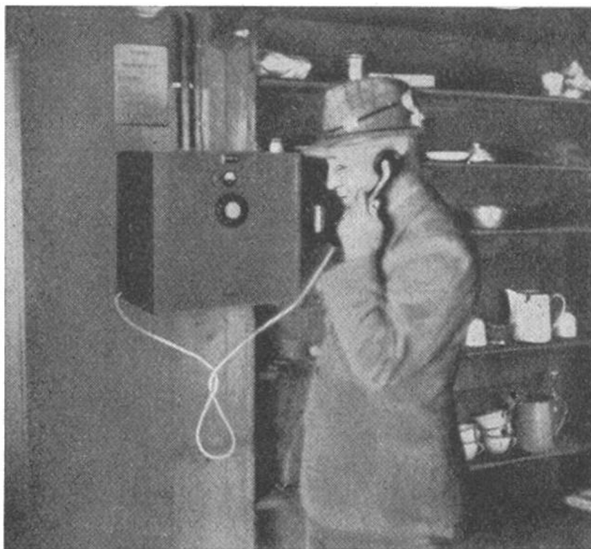
Telephon-Apparat in der Monte-Rosa-Hütte. Es besteht eine drahtlose Verbindung mit der Station Gornergrat. Von hier aus wird das Gespräch per Draht weitergeleitet.
