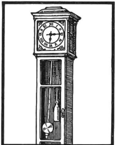
**Pendeluhr mit „Anker“.** Im 17. Jahrh. verschafften zwei wichtige Fortschritte der Räderuhr allgemeine Anerkennung. Da die Schwingungen des Pendels von gleicher Dauer sind, benutzte man dieses an Stelle der Waage als Regulator. Die beiden Flügel an der Achse der früheren Spindelhemmung ersetzte man durch einen zweiarmigen „Anker“. So entstand die Pendeluhr, die eine genaue Zeitbestimmung ermöglicht.
