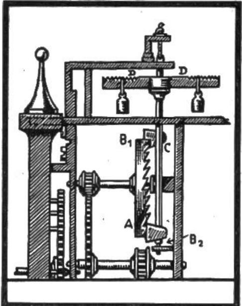
**Regulator der Räderuhr.** Das abrollende Gewicht an der Räderuhr würde ohne Hemmung das Laufwerk in einem Zuge abhaspeln. Um den Gang zu verlangsamen und regelmässig zu gestalten, war ein Regulator notwendig. Man benutzte dazu die sog. Spindelhemmung; das Zahnräder A ergreift abwechselungsweise die Flügel B 1 und B 2 der Achse C und dreht dadurch die mit kleinen Gewichten beladene Waage D hin u. her.
