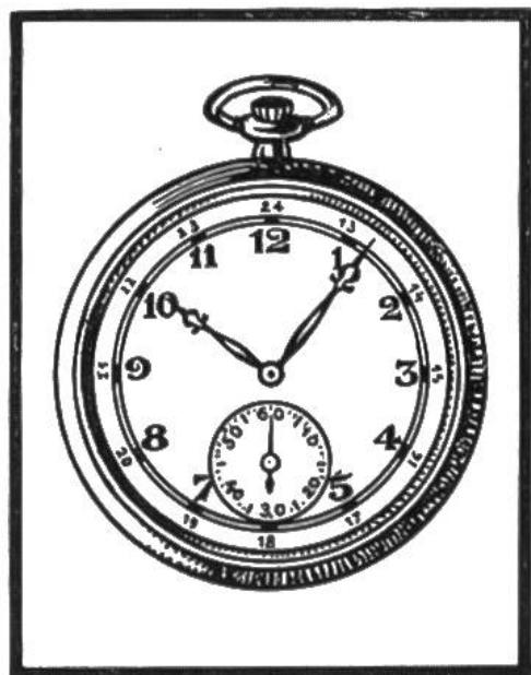
**Die moderne Taschenuhr** ist auf den gleichen Grundlagen aufgebaut und hat durch die Fortschritte in der Präzisionsmechanik noch bedeutende Verbesserungen erfahren. Der Schlüssel, mit dem man die Uhren früher aufzog, wurde durch eine Vorrichtung (Remontoir) beim Aufhängebügel ersetzt. Die heutige Uhr ist ein kleines Wunderwerk, das seine Entstehung jahrhundertelanger Arbeit menschl. Geistes verdankt.
