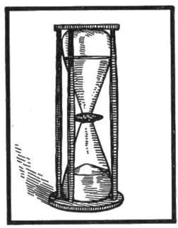
Sanduhr. Bis weit über das Mittelalter hinaus verwendete man die Sanduhr hauptsächlich im Hausgebrauch. Aus dem oberen Teile eines Glasgefässes fällt durch ein enges Loch feiner Sand in den untern Teil. Sobald aller Sand durchgerieselt ist, wird das Gefäss umgedreht, der Vorgang wiederholt sich, immer in der gleichen Zeitspanne. Sanduhren mit 4 Gefässen gaben den Ablauf von ½, ½, ¾ und 1 Stunde bekannt.
