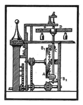
Regulator der Räderuhr. Das abrollende Gewicht an der Räderuhr würde ohne Hemmung das Laufwerk in einem Zuge abhaspeln. Um den Gang zu verlangsamen und regelmässig zu gestalten, war ein Regulator notwendig. Man benutzte dazu die sog. Spindelhemmung; das Zahnrad A ergreift abwechslungsweise die Flügel B 1 und B 2 der Achse C und dreht dadurch die mit kleinen Gewichten beladene Waage D hin u.her.
