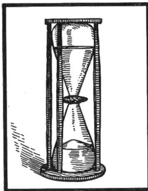
**Sanduhr.** Bis weit über das Mittelalter hinaus verwendete man die Sanduhr hauptsächlich im Hausgebrauch. Aus dem oberen Teile eines Glasgefäßes fällt durch ein enges Loch feiner Sand in den untern Teil. Sobald aller Sand durchgerieselt ist, wird das Gefäß umgedreht, der Vorgang wiederholt sich, immer in der gleichen Zeitspanne. Sanduhren mit 4 Gefäßen gaben den Ablauf von  $\frac{1}{4}$ ,  $\frac{1}{2}$ ,  $\frac{3}{4}$  und 1 Stunde bekannt.
