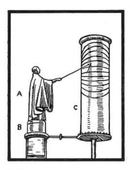
Wasseruhr mit Zeiger. Sie trug statt der Zahnradstange eine kleine Figur A auf dem Schwimmkolben B, die mit einem Stabe auf den Zylinder C hinwies, welcher die Zeiteinteilung trug. Der aufsteigende Kolben drehte durch ein Zahnrad den Zylinder einmal im Jahre herum; dadurch war im Sommer die breitere, im Winter die schmälere Seite der Stundenringe zu sehen und die Uhr den versch. Tageslängen angepasst.
