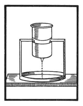
Wasser in ein Becken einfliessen zu lassen, füllte man einen Behälter damit und liess die Flüssigkeit durch ein enges Röhrchen langsam abtropfen. Die gleiche Menge Wasser läuft stets in derselben Zeit ab und ermöglicht auf diese Weise eine ungefähre Einteilung. Zur Zeit des Königs Asurbanipal, 640 Jahre v. Chr., benutzten die Assyrer Wasseruhren dieser Art, ebenso andere Völker.
