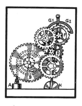
Beim Räderwerk der Pendeluhr überträgt das Gewicht A die Bewegung auf die Zahnräder B, C, D, E und F. Das Rad F drückt auf den mit Pendel H verbundenen Ankerarm G1 und macht das Pendel nach links schwingen; das Rad F wird einen Augenblick frei, ein Zahn schlüpft durch, nun greift der Ankerarm G2 hemmend ins Rad F, das Pendel schwingt zurück, Rad F drückt wieder auf Arm G1 usw.
