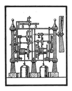
Räder= und Gewichtsuhren verdrängten (vom Anfang des 14. Jahrh. an) allmählich die älteren Zeitmesser. Die treibende Kraft ist das von einer Walze abrollende Gewicht. Die Walze ist mit einem Zahnrad versehen, welches die Umdrehungen auf andere Zahnräder u. zuletzt durch Waagebalken auf die Zeiger überträgt. Eines der vollkommensten dieser alten Uhrwerke wurde 1370 auf dem Pariser Schlossturm aufgestellt.
