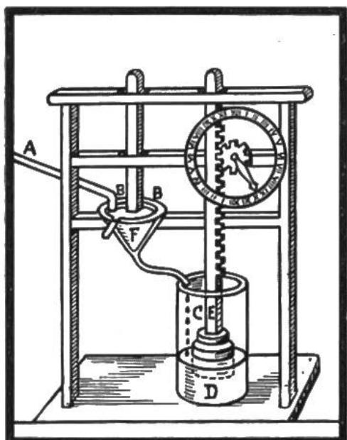
**Wasseruhr, 300 v. Chr.** Eine grosse Vervollkommenung brachte die 300 v. Chr. in Ägypten gebräuchliche Wasseruhr. Das Wasser fliesst von der Röhre A durch den Trichter B nach dem Zylinder C. Die Schwimmkraft des Kolbens D hebt die Zahnschraube E, wodurch der Zeiger gedreht wird. Durch Verstellung des Kegels F konnte man die Wasserzufuhr ändern, entsprechend der Tages- und Nachtlänge je nach Jahreszeit.
