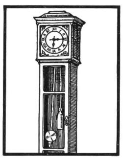
Pendeluhr mit "Anker". Im 17. Jahrh. verschafften zwei wichtige Fortschritte der Räderuhr allgemeine Anerkennung. Da die Schwingungen des Pendels von gleicher Dauer sind, benutzte man dieses an Stelle der Waage als Regulator. Die beiden Flügel an der Achse der frühern Spindelhemmung ersetzte man durch einen zweiarmigen "Anker". So entstand die Pendeluhr, die eine genaue Zeitbestimmung ermöglicht.
