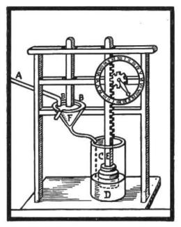
Wasseruhr, 300 v. Chr. Eine grosse Vervollkommnung brachte die 300 v. Chr. in Ägypten gebräuchliche Wasseruhr. Das Wasser fliesst von der Röhre A durch den Trichter B nach dem Zylinder C. Die Schwimmkraft des Kolbens D hebt die Zahnstange E, wodurch der Zeiger gedreht wird. Durch Verstellung des Kegels F konnte man die Wasserzufuhr ändern, entsprechend der Tagesund Nachtlänge je nach Jahreszeit.
