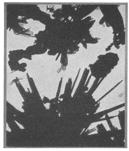
Starke Vergrösserung von Eisenrost. Die photographische Aufnahme wurde im Übermikroskop hergestellt. Die rauhe Oberfläche, die der Rost am Eisen bildet, entpuppt sich hier als unzählige scharfkantige, spitze Kristalle.
