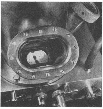
Durch das luftdicht verschlossene Einblickfenster ist das bis zu 30000fach vergrösserte Objekt auf dem Fluoreszenzschirm hell und deutlich zu erkennen.
