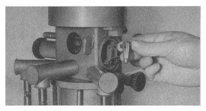
Das zu untersuchende Objekt wird in einer besondern Kapsel, Patrone genannt, sorgfältig "verpackt". Die Patrone gelangt durch eine Schleusvorrichtung (ähnlich den Lichtschleusen bei Verdunkelung) in den luftleeren Innenraum des Übermikroskops.
