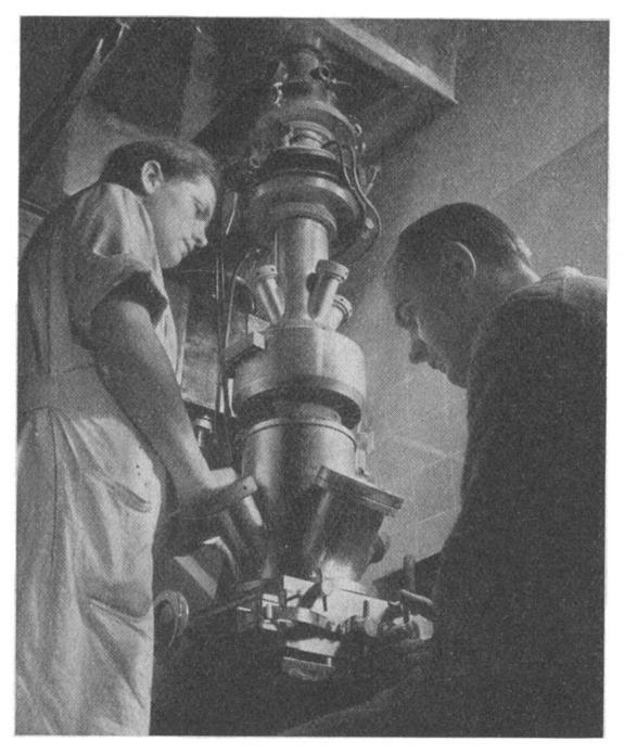
Dieses Übermikroskop ermöglicht eine 30000-fache Vergrösserung. Sein Geheimnis besteht darin, dass es mit Elektronenstrahlen arbeitet, die bei Spannungen von 100000 Volt erzeugt werden.
