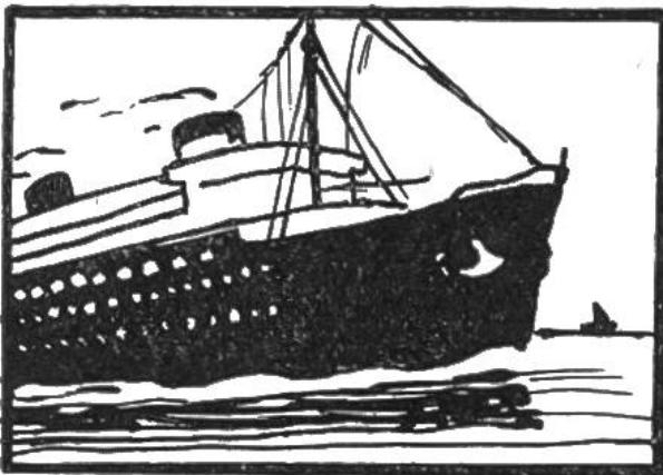
**Heizölbedarf für Ozeanüberquerung.** Ein moderner Riesendampfer benötigt zur einmaligen Fahrt über den Atlantischen Ozean für den Antrieb der riesigen Turbinen 5—6000 Tonnen Heizöl. Die Anbordnahme dieser Schwerölmengen mittels langer
