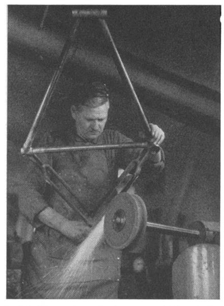
Schleifen des Rahmens. Meisterhaft lassen die Schleifer die Rohrteile über die rotierende Scheibe gleiten. Die gespannte Aufmerksamkeit im Gesichte verrät uns, dass hier verantwortungsvolle Arbeit geleistet wird.
