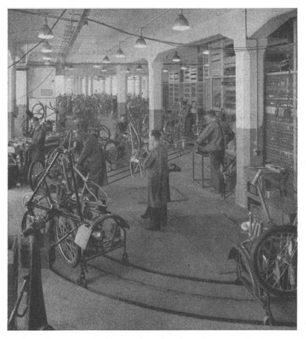
In der Montagehalle entsteht das fertige Fahrrad. Auf einem kleinen Wagen liegen die erforderlichen Teile bereit. In kurzer Zeit ist ein Rad fix und fertig montiert und versandfertig verpackt.
