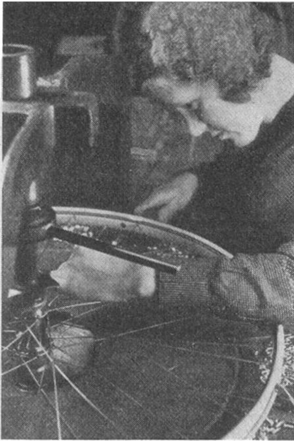
Das Einziehen der Speichen verlangt vollste Aufmerksamkeit und eine ruhige, sichere Hand!
