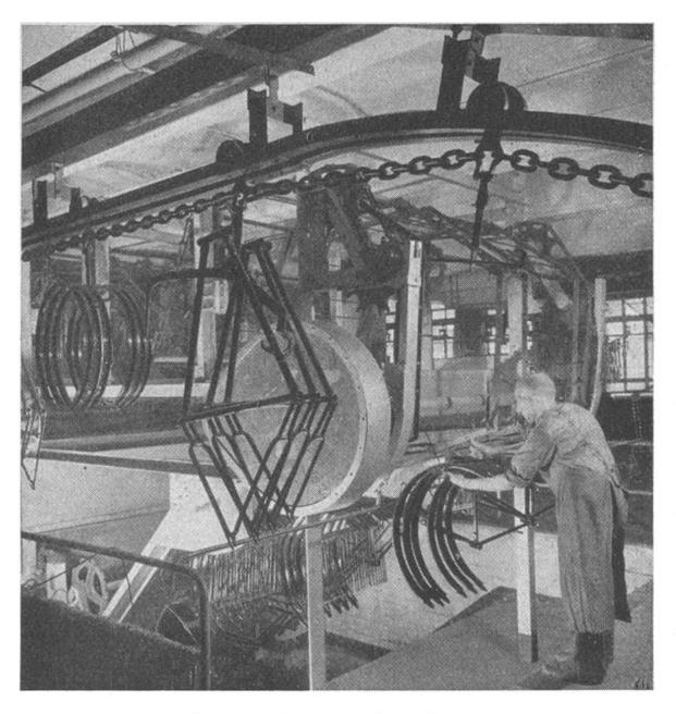
In grossen ausländischen Fahrradfabriken leiten Transportketten oder laufende Bänder die verschiedenen Bestandteile weiter. Hier führt die Transportkette die fertig lackierten Stücke aus dem Lackbrandofen. Zäh und fest ist die Lackierung. Man kann zwei Rohre so kräftig aufeinanderschlagen, dass es Beulen gibt, der Lack springt nicht ab.
