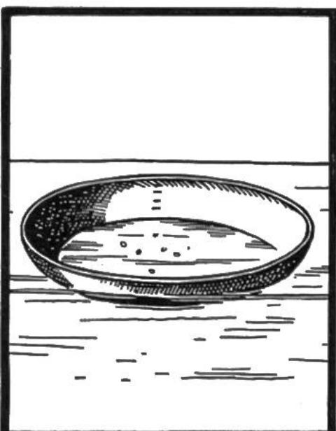
**Einfache Wasseruhr.** Durch Jahrhunderte hindurch wurde die Zeit auf mancherlei Art mit Hilfe des Wassers gemessen. Man stellte ein Becken mit feinem einen Loch in der Mitte des Bodens ins Wasser. Die Zeit, die das Wasser braucht, um durch das Loch eindringend das Becken zu füllen, ist stets die gleiche. Auf der Innenseite des Beckens befand sich eine Art Maßstab, der die verflossenen Stunden angab.
