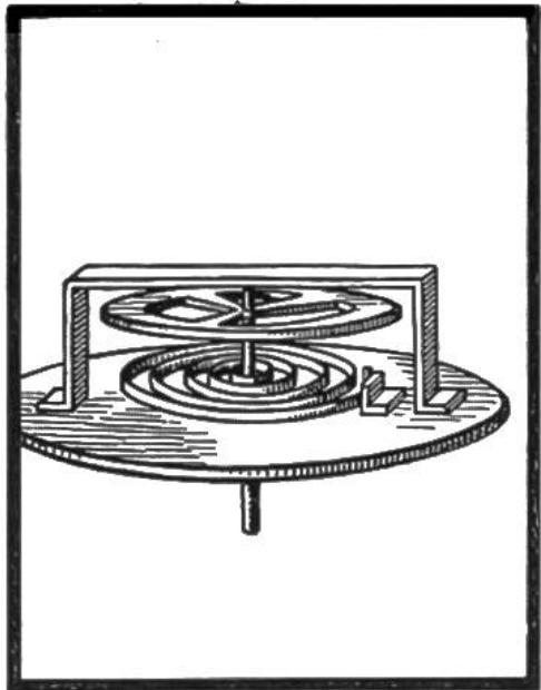
**Spiralfeder mit „Schwungrad“ (Balancier).** Die Enden der Feder sind an der Achse des Rades und auf der Grundplatte befestigt. Dreht man das Schwungrad, dass die Spiralfeder gespannt wird, so hat diese das Bestreben, wieder in die ursprüngliche Lage zurückzuschwingen, geht aber infolge der Elastizität weiter und vollführt, das Schwungrad mitführend, so regelmässige Schwingungen wie das Pendel.
