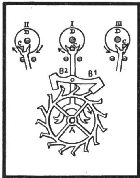
**Anker und „Unruhe“.** Wie bei der Pendeluhr drücken die Zähne des Rades A auf den Ankerarm B 1; der Anker greift in den Zapfen C, dreht die „Unruhe“ D nach links, spannt die Spiralfeder und lässt den Arm B 2 hemmend in das Rad A eingreifen. Die gespannte Feder treibt die „Unruhe“ sofort wieder nach rechts, wobei der Zapfen C die Hemmung des Ankerarmes B 2 löst; ein Zahn schlüpft durch, usw.
