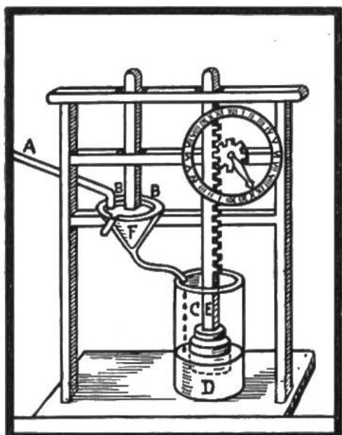
**Wasseruhr, 300 v. Chr.** Eine grosse Vervollkommenung brachte die 300 v. Chr. in Ägypten gebräuchliche Wasseruhr. Das Wasser fliesst von der Röhre A durch den Trichter B nach dem Zylinder C. Die Schwimmkraft des Kolbens D hebt die Zahnhastange E, wodurch der Zeiger gedreht wird. Durch Verstellung des Kegels F konnte man die Wasserzufuhr ändern, entsprechend der Tages- und Nachtlänge je nach Jahreszeit.
