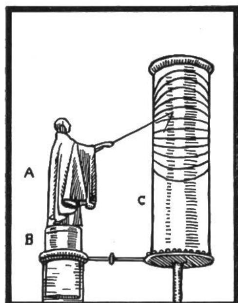
**Wasseruhr mit Zeiger.** Sie trug statt der Zahnrädstange eine kleine Figur A auf dem Schwimmkolben B, die mit einem Stabe auf den Zylinder C hinwies, welcher die Zeiteinteilung trug. Der aufsteigende Kolben drehte durch ein Zahnräder den Zylinder einmal im Jahre herum; dadurch war im Sommer die breitere, im Winter die schmälere Seite der Stundenringe zu sehen und die Uhr den versch. Tageslängen angepasst.
