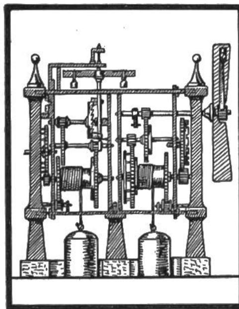
**Räder- und Gewichtsuhr** verdrängten (vom Anfang des 14. Jahrh. an) allmählich die älteren Zeitmesser. Die treibende Kraft ist das von einer Walze abrollende Gewicht. Die Walze ist mit einem Zahnrad versehen, welches die Umdrehungen auf andere Zahnräder u. zuletzt durch Waagebalken auf die Zeiger überträgt. Eines der vollkommensten dieser alten Uhrwerke wurde 1370 auf dem Pariser Schlossturm aufgestellt.
