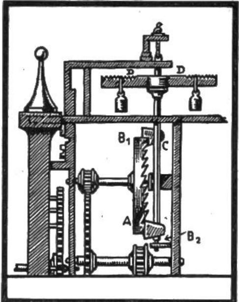
**Regulator der Räderuhr.** Das abrollende Gewicht an der Räderuhr würde ohne Hemmung das Laufwerk in einem Zuge abhaspeln. Um den Gang zu verlangsamen und regelmässig zu gestalten, war ein Regulator notwendig. Man benutzte dazu die sog. Spindelhemmung; das Zahnräder A ergreift abwechselnd die Flügel B 1 und B 2 der Achse C und dreht dadurch die mit kleinen Gewichten beladene Waage D hin u. her.
