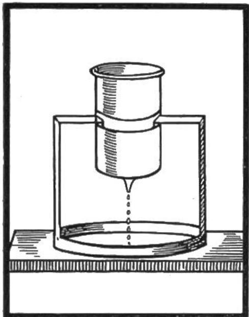
**Wasseruhr, 640 v. Chr.** Statt das Wasser in ein Becken einfließen zu lassen, füllte man einen Behälter damit und liess die Flüssigkeit durch ein enges Röhrchen langsam abtropfen. Die gleiche Menge Wasser läuft stets in derselben Zeit ab und ermöglicht auf diese Weise eine ungefähre Einteilung. Zur Zeit des Königs Asurbanipal, 640 Jahre v. Chr., benutzten die Assyrer Wasseruhren dieser Art, ebenso andere Völker.
