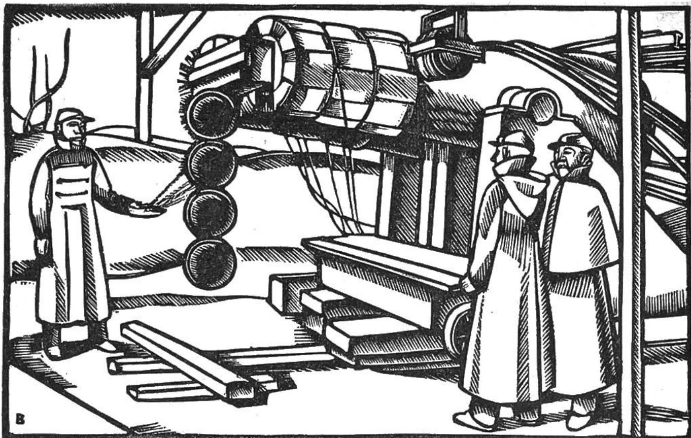
Mit einem **Riesen-Elektromagneten** wurden 1888 nahe b. New York interessante Versuche gemacht, um die Wechselwirkungen von elektr. Strom u. Magnetismus zu studieren. Major King wandelte 2 Kanonenrohre in Magnete um; er umwickelte sie mit etwa 14 km Kupferdraht. Sobald Strom durch den Draht geleitet wurde, vermochte der Riesenmagnet z. B. 4 Geschosse von je 145 kg Gewicht anzu ziehen. Moderne Lasthebemagnete tragen bis 75 000 kg.
