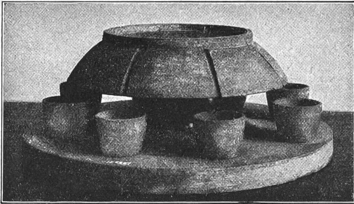
Ein Erdbebenmesser aus dem Jahre 1703. Die grosse Schale ist mit Quecksilber gefüllt, das bei geringer Erschütterung des Bodens durch die Rinnen herausfliesst. (Photographie des Deutschen Museums.)
