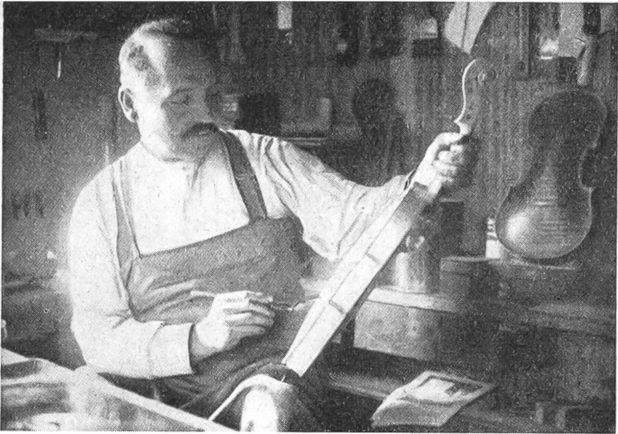
Geigenmacher beim Lackieren einer Geige.
