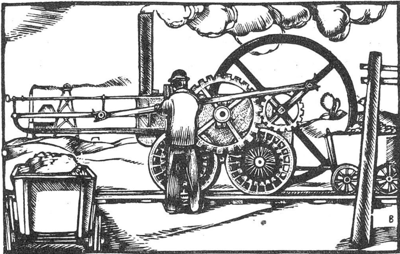
**Die Lokomotive Trevithicks von 1804.** Trevithick fasste als erster den kühnen Gedanken, einen Dampfwagen auf glatten, eisernen Schienen laufen zu lassen. Zwar bewährte sich seine „Lokomotive“, die zur Roheisenbeförderung in Südwales verwendet wurde, nicht, doch er hatte durch die Verwendung v. Schienen den Weg gewiesen, auf dem die Eisenbahn entwicklungsfähig war. Die erste brauchbare Lokomotive von Stephenson befuhrt 1825 die 1. Eisenbahnlinie der Welt.
