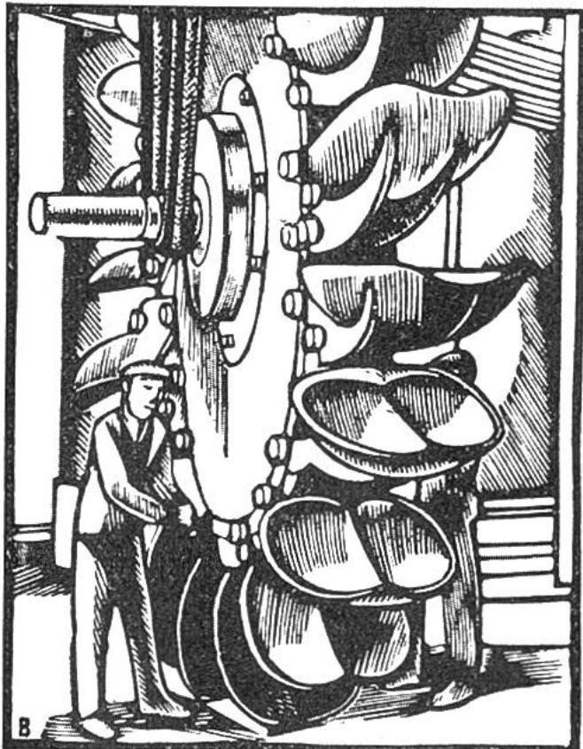
**Die Wasserturbine** ist eine geniale Erfindung und für unser wasserreiches Land von grosser Bedeutung. Unvergleichlich besser als das alte Wasserrad wandelt sie die strömende Kraft des Wassers in eine drehende Bewegung um, die ihrerseits ausgenutzt wird, z. B. zur Erzeugung elektr. Energie. In den letzten 100 Jahren sind verschiedene Systeme zu leistungsfähigen Maschinen ausgebildet worden. Das Peltonrad (Bild) ist aus dem „Löffelrad“ des Schweizer Ing. Zuppinger von 1846 entstanden.
