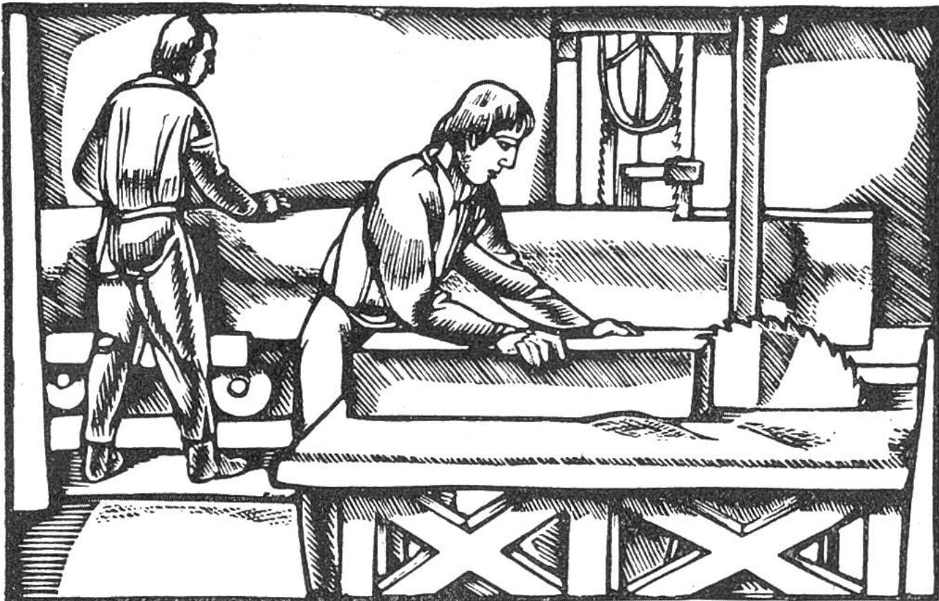
**Kreis- und Bandsäge.** Zu den wichtigsten Werkzeugen, welche die Menschen von jeher handhabten, gehört die Säge. Eine gewaltige Verbesserung für die Holz- und Metallverarbeitung, zum Ab- und Einschneiden, bedeutete die Kreissäge, eine „Säge ohne Ende“. Sie wurde 1755 von Albert in Paris erfunden und 1805 von M. J. Brunel in England eingeführt. Im Jahre 1807 erfand dann der engl. Ingenieur Newbury die bandförmige Säge.
