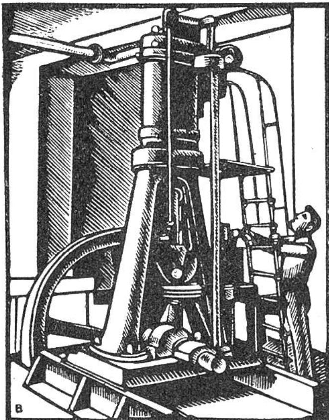
**Der erste Dieselmotor, 1897.** Der Erfinder Diesel ging vom Gedanken aus, für die Dampfmaschine einen sparsameren Ersatz zu schaffen. Nach jahrelangen Versuchen, auch bei Sulzer in Winterthur, entstand eine Verbrennungskraftmaschine, welche der Weltwirtschaft zu höchstem Nutzen gereicht. Durch Verwendung des billigeren Schweröls, bessere Brennstoffausnützung, reinlichen, gefahrlosen Betrieb und geringen Raumbedarf eignet sich der Dieselmotor besonders für Schiff, Bahn, Auto, Flugzeug.
