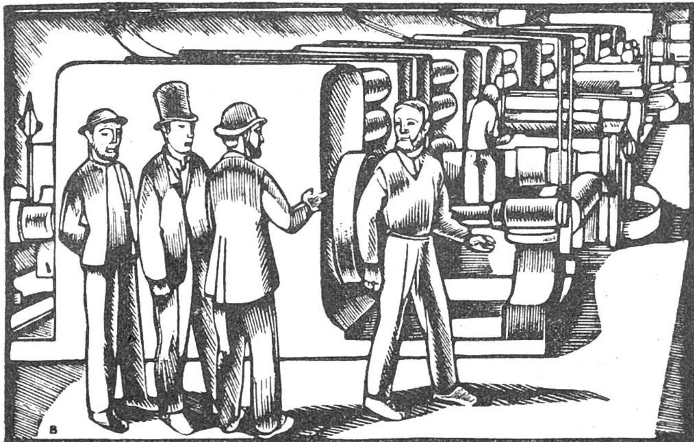
**Das erste Elektrizitätswerk** wurde 1882 in New York in Betrieb gesetzt. Den Strom lieferte eine direkt mit einer Dampfmaschine verbundene Dynamomaschine (Generator), die der grosse amerik. Techniker Edison erbaut hatte (Bild). Die erste derartige Kraftstation war auf der internat. Elektrizitätsausstellung 1881 in Paris als ein Weltwunder angestaunt worden. In der Schweiz werden als Antrieb für die Generatoren Wasserturbinen verwendet.
