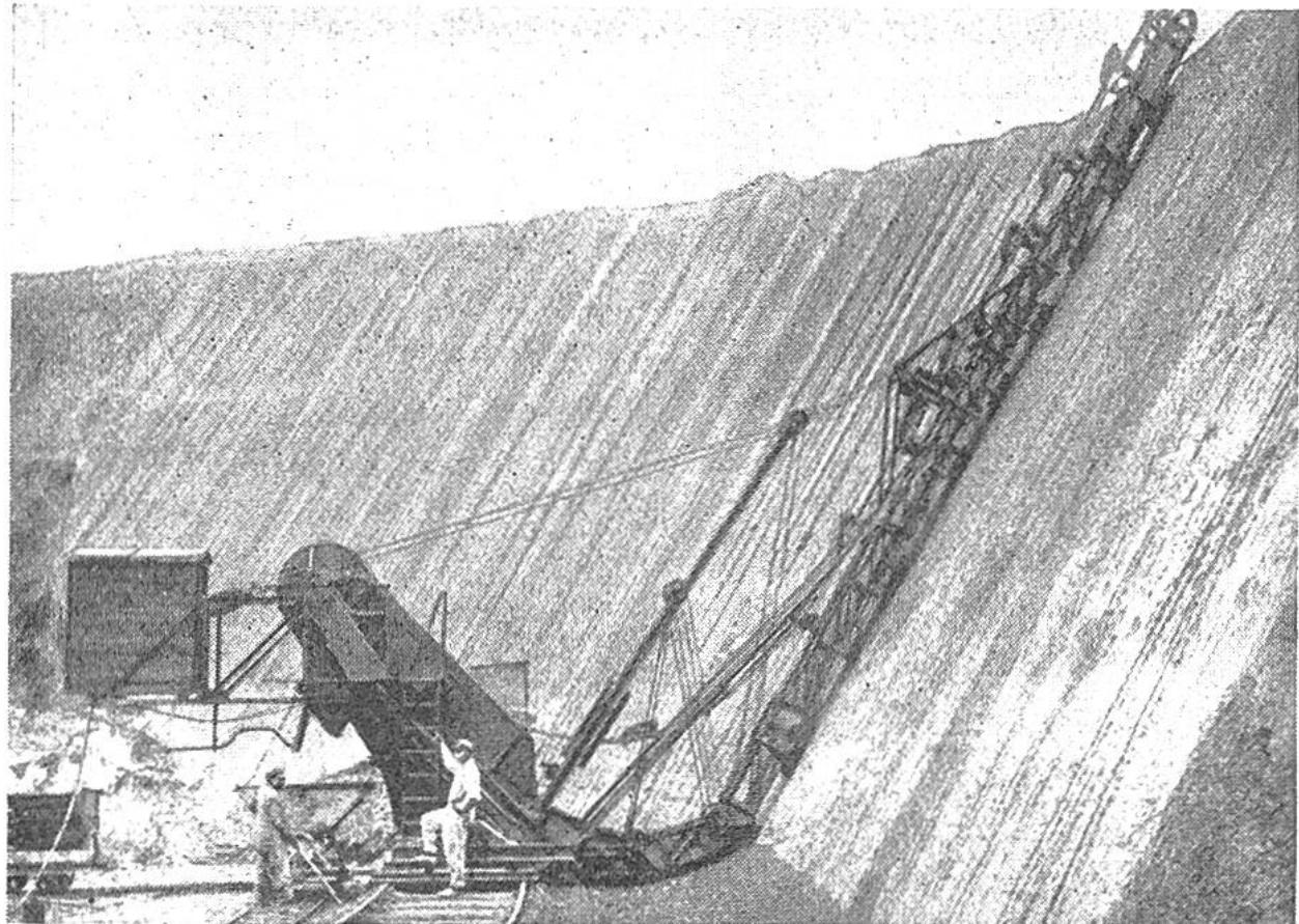
Eimerbagger mit Hochleiterausrüstung in einer grossen Lehmgrube. Die Eimer laufen auf einer endlosen Kette; im Abwärtsgang kratzen sie den Lehm von der Grubenwand ab; der Lehm fällt dann in die bereitgestellten Rollwagen. Bagger werden auch oft oberhalb der Grube aufgestellt; wenn dies der Fall, wird das Material durch die Eimerkette von unten nach oben befördert.
