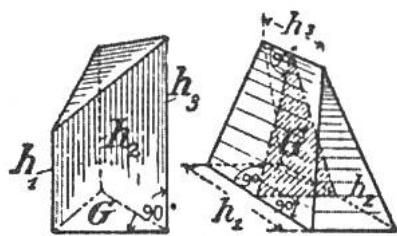
Schiefabgeschnittenes Prisma:Flächeninhalt des senkrechten Querschnittes =  $G$ .Länge der Kanten =  $h, h_1, h_2, \dots, h_n$ ,
