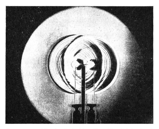
Photographierte Schallwellen. Zwei kleine Lautsprecher haben je einen kurzen, scharfen Laut erzeugt. Man sieht deutlich, wie sich die Schallwellen wie Wellen auf einer Wasserfläche, in die ein Stein geworfen wurde, kreisförmig ausbreiten. Sehr auffallend ist aber, dass die sich kreuzenden Schallwellen ihren Weg ungestört weiter verfolgen.
