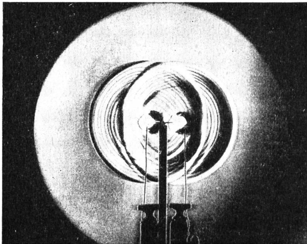
Photographierte Schallwellen. Zwei kleine Lautsprecher haben je einen kurzen, scharfen Laut erzeugt. Man sieht deutlich, wie sich die Schallwellen wie Wellen auf einer Wasserfläche, in die ein Stein geworfen wurde, kreisförmig ausbreiten. Sehr auffallend ist aber, dass die sich kreuzenden Schallwellen ihren Weg ungestört weiter verfolgen.
