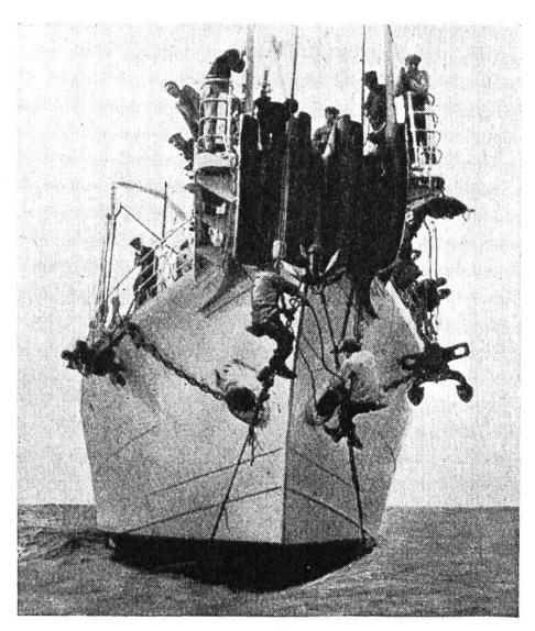
Das Kabelschiff auf der Störsuche. Mit dem Greifanker wird das defekte Kabel vom Meeresgrund em porgezogen und untersucht.
