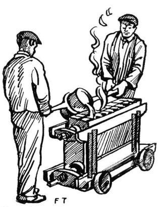
Das flüssige Metall wird in Schienenform gegossen.
