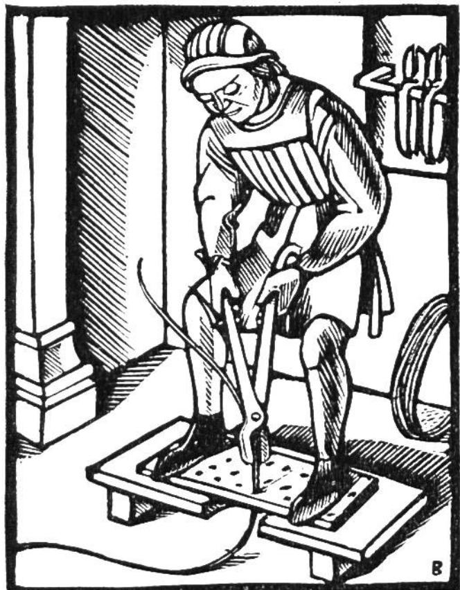
**Mittelalterlicher Drahtzieher am Zieheisen.** Seitdem der Mensch die Verwendung und Bearbeitung von Metallen beherrscht, wurde Draht hergestellt und auf mannigfache Art verarbeitet: zu Stiften, Nägeln und Ketten. Im frühen Mittelalter kam das Zieheisen auf: eine gelochte Metallplatte. Trotzdem heute grosse Mengen von Draht durch maschinennässiges Walzen gewonnen werden, ist das Zieheisen für die Herstellung besonders feiner Drahtsorten (Golddraht) immer noch unentbehrlich.
