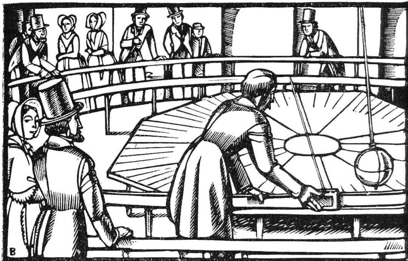
**Die Achsendrehung der Erde** wurde durch den berühmten ‚Foucault’schen Pendelversuch‘ im Jahre 1851 auf anschauliche Art bewiesen. Foucault brachte in der Kuppel des Pantheon in Paris ein über 80 m langes Pendel in Schwingung. Ein Pendel behält die ursprüngliche Richtung bei. Foucault beobachtete nun, dass die Schwingungen mit der Zeit immer mehr von der anfänglichen Meridianrichtung abwichen und zwar genau in vorausberechnetem Masse.
