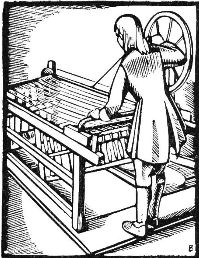
**Die Spinnmaschine.** Durch die Erfindung des mechanisch bewegten Schiffchens war die Weberei bedeutend leistungsfähiger geworden. Der arme Weber Hargreaves musste seine Arbeit oft unterbrechen, weil ihm seine Frau nicht genügend Garn zum Verweben spinnen konnte; da ersann er eine Maschine, die gleichzeitig 8 Fäden spann (1764). Nun folgten bald weitere grundlegende Erfindungen, und die mechanische Spinnerei entwickelte sich zu einer wichtigen Industrie (Schweiz: ca. 1,7 Mill. Spindeln).
