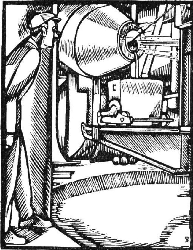
Die „Bessemer-Birne“ gestaltete den gesamten Prozess der Stahlherzeugung vollständig um. Der engl. Hüttenbesitzer Bessemer erfand 1855 das nach ihm benannte Verfahren zur direkten Umwandlung von geschmolzenem Gusseisen in Schmiedeisen und Stahl durch Einblasen von Luft in die „Bessemer-Birne“. Dies kürzte die vorher benötigte Arbeitszeit von  $1\frac{1}{2}$  Tagen auf 20 Minuten ab. Die grossartige Erfindung trug viel dazu bei, dass Eisen u. Stahl im 19. Jahrh. die Hauptwerkstoffe wurden.
