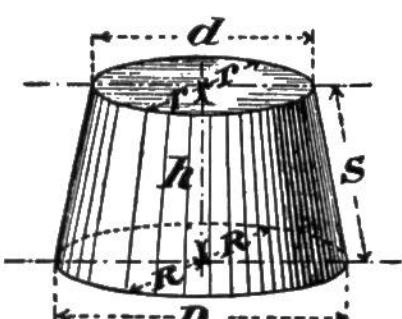
Abgestumpfter Kegel:Radien der parallelen Endflächen =  $R$  und  $r$ ,Durchmesser =  $D$  und  $d$ , Höhe =  $h$ , Seite =  $s$ ,Inhalt  $K = \frac{1}{3} \pi h (R^2 + Rr + r^2)$ Mantel  $M = \pi s (R + r)$ .Oberfläche  $O = \pi [R^2 + r^2 + (R+r)s]$ .
