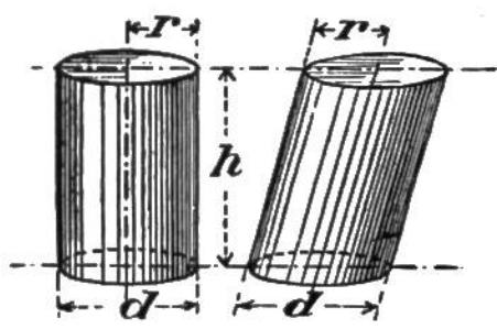
Cylinder (Walze)Radius =  $r$ , Durchmesser =  $d$ , Höhe =  $h$ Inhalt  $K = r^2 \pi h$  oder  $\frac{d^2}{4} \pi h$
