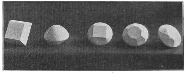
Diamanten! Aber nicht edles, funkelndes Gestein, sondern Gipsmodelle, die den Schülern den Arbeitsgang beim Diamantenschleifen veranschaulichen
