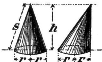
Kegel:Radius der Grundfläche =  $r$ .Höhe =  $h$ , Seite =  $s = \sqrt{r^2 + h^2}$ ,Mantel  $M = \pi r \sqrt{r^2 + h^2}$  oder  $\pi r s$ ,Oberfläche =  $\pi r^2 + r \pi s$  oder  $r \pi (r+s)$ oder =  $\pi r (r + \sqrt{r^2 + h^2})$ .Inhalt  $K = \frac{1}{3} r^2 \pi h$ ,
