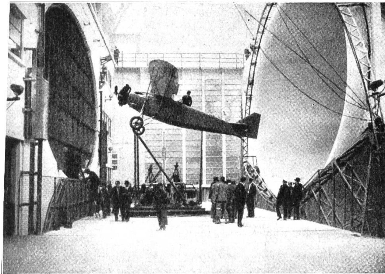
Ein Flugzeug vor der Prüfung. Aus der grossen Öffnung links werden orkanartige Luftströme das Flugzeug umbauen. Dabei wird man beobachten, wie sich das Flugzeug bei Steuerung, Auftrieb, Niedergang und andern Beanspruchungen verhält.
