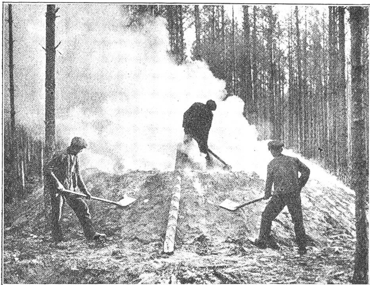
Die Farbe des Rauches gibt dem Köhler an, ob das Holz im Innern des Meilers richtig verkohlt ist. Die Meiler sinken bei dieser Umwandlung des Holzes in Holzkohle stark in sich zusammen.
