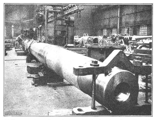
Teilstück der "Antriebswelle" wird in einer Fabrikwerkstätte bearbeitet. Dieser gewaltige "Wellbaum" soll die Kraft der Turbinen auf die hinten am Schiff befindlichen Schiffschrauben übertragen. Durch die Drehung der propellerartigen Schiffschrauben wird das Schiff in Bewegung gesetzt.
