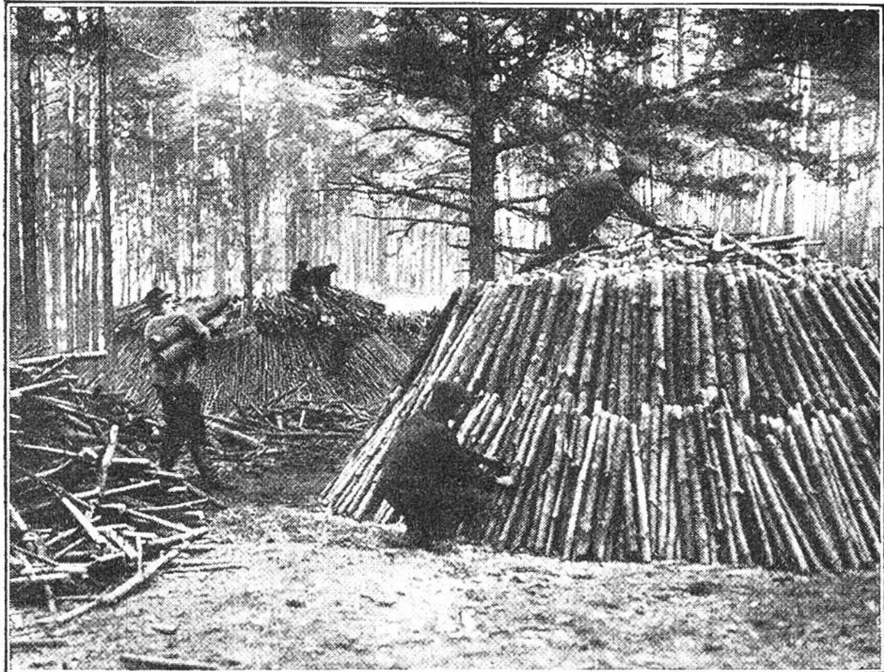
Das Aufschichten des Holzes für den Meiler. Um die Luftzufuhr während des Verbrennens auf ein Mindestmass herabzusetzen, werden die Meiler mit Erde bedeckt.
