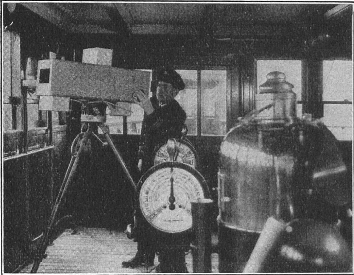
Hier sehen wir die Nebelkamera auf der Kommandobrücke. Durch die Gläser auf der Rückseite des Apparates blickt der Offizier auf die entwickelte Platte. Nun weiss er, ob er mit Volldampf vorausfahren darf.
