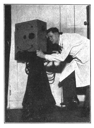
Mit diesem Apparat werden 80000 Bilder in der Sekunde aufgenommen. Der Filmrollt mit einer Geschwindigkeit von 20 Metern in der Sekunde. Ein Wiederaufrollen ist unmöglich. Die belichteten Filmbänder fallen in den schwarzen Sack unterhalb d. Apparates.
