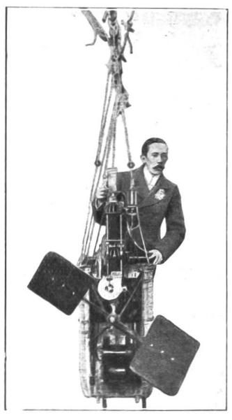
Der Brasilianer Santos Dumont im Korb seines Freiballons. Er hatte als ersterim Jahre 1898 die Idee, einen Petrolmotor in die Ballongondel einzubauen. Die Maschine setzte einen zweischaufligen Propeller in Bewegung.
