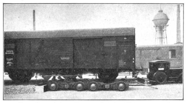
Von einer niedern Rampe wird der Güterwagen auf das fahrbare Anschlussgeleise geschoben. Dieses Fahrgestell hat eine Tragfähigkeit von 32 Tonnen.
