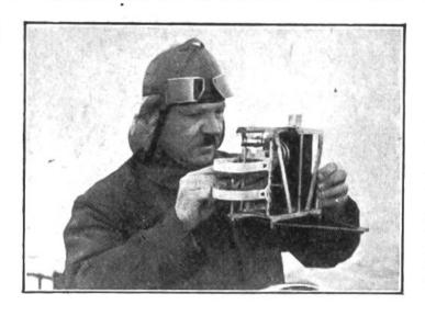
Der Meteorograph (= Wetteraufschreibe-Apparat), der selbsttätig Luftdruck, Temperatur, Feuchtigkeit in den höheren Luftschichten feststellt und auf eine russgeschwärzte Trommel aufzeichnet, wird vom Wetter-Kundschafter abgelesen.
