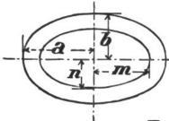
Elliptischer Ring: Halbe Achsen der äussern Ellipse=a,b, Halbe Achsen der innern Ellipse - m,n, Fläche:  $F = \pi(ab-mn)$ .
