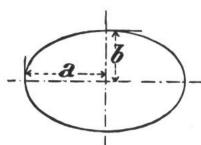
Ellipse: Halbe grosse Achse = a, Halbe Kleine Achse - b. Fläche  $F = a.b.\pi$ ,
