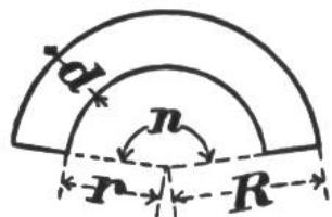
Kreisringstück (Konzentrisch)Aeusserer Radius =  $R$ ,Innener Radius =  $r$ ,Zentriwinkel =  $n$ , radiale Breite =  $d$ ,
