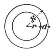
Aeusserer Radius = R. Innerer Radius = r  $F = R^2 \pi - r^2 \pi. = \pi(R+r).(R-r).$ menn d = radiale Breite des Kreisrings so ist  $F = \pi(2r+d)$ . d
