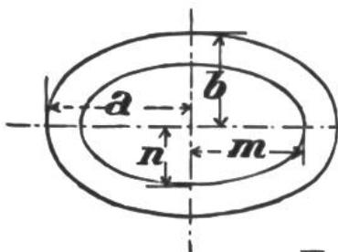
Elliptischer Ring:Halbe Achsen der äussern Ellipse =  $a, b$ ,Halbe Achsen der innern Ellipse =  $m, n$ ,
