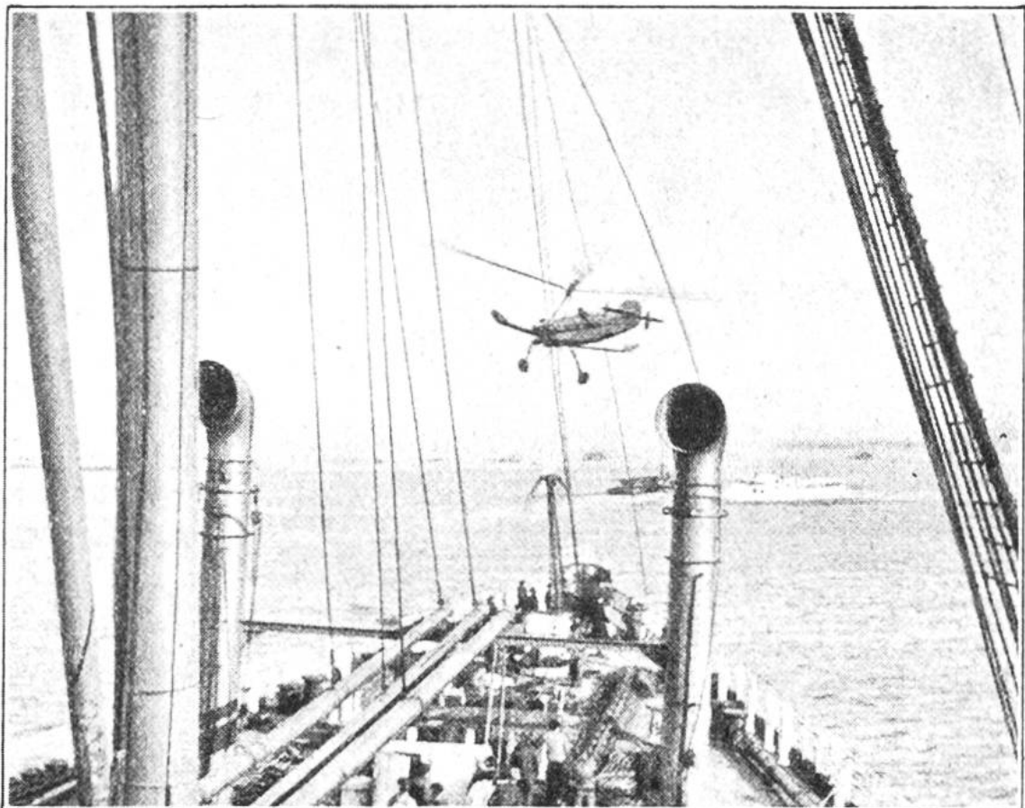
Das Autogiro- oder Windmühlenflugzeug, das die Fähigkeit hat, sehr steil in die Höhe zu starten und ebenso zu landen.
