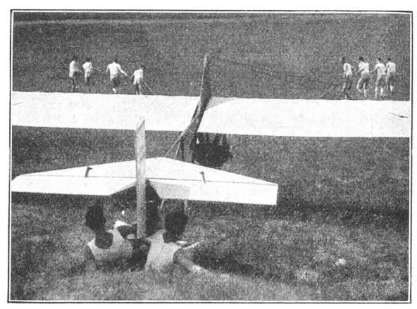
Das Segelflugzeug ist startbereit. Die zwei Mann im Bildvordergrund halten das Flugzeug fest, während vorn die Startmannschaft ein an der Flugzeugspitze eingehaktes Gummiseil im Lauf anspannt. Beim Loslassen des Seils wird das Flugzeug in die Luft geschnellt.
