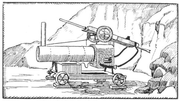
Die erste Gesteinsbohrmaschine, die durch Dampf betätigt wurde, aus dem Jahre 1849.
