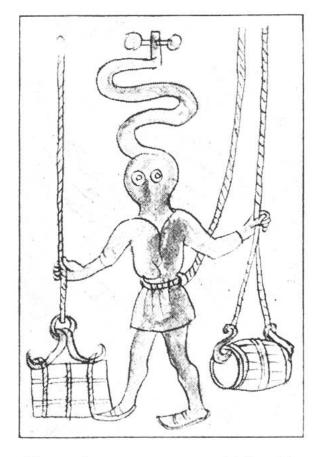
Taucheranzug mit Luftschlauch, der die Atmung unter Wasser ermöglicht, nach der Zeichnung eines unbekannten Erfinders um 1430.
