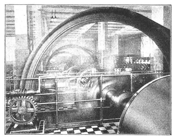
Maschinen in vollem Arbeitsgang. Es sind dampfbetriebene Kompressionsmaschinen, welche Ammoniak unter Druck setzen, so dass es sich als Gas verflüchtigt. Bei diesem Vorgang stellt sich grosse Kälte ein, die Wasser in Kästen zum Gefrieren bringt.
