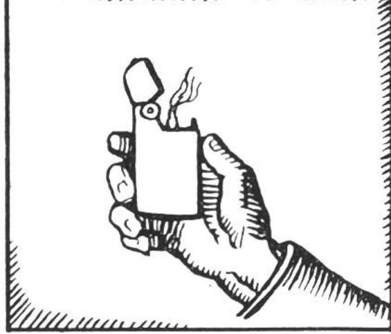
Trotz vervollkommenter Zündhölzer wurde versucht, verbesserte Feuerzeuge, nach dem Prinzip der alten Gewehrzündung, zu erstellen. Brauchbar wurden sie erst durch Verwendung von Cereisen zum Funken schlagen und Benzin zur Zündung.
